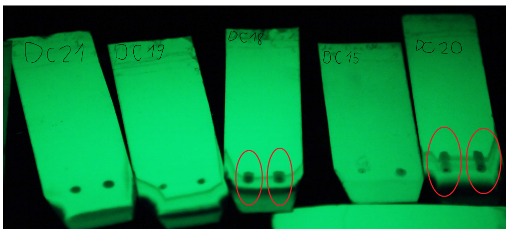
Abbildung 4.1.: Dünnschichtchromatographien von Uranylacetat auf Aluminiumoxid; Zu sehen sind fünf Chromatogramme von Uranylacetat beleuchtet mit UV-Licht der Wellenlänge 254 nm. Die unterschiedlichen Einflüsse des Laufmittels auf die Proben sind ersichtlich. Das bei manchen Proben gebildete Tailing ist rot eingekreist.
