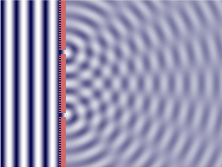
Bild 2: Beugung und Interferenz: von links falle eine Welle auf eine absorbierende Blende ein. Die Blende habe zwei winzige Löcher (Spalte); jenseits der Blende geht von jeder Öffnung eine Kugelwelle aus: das Phänomen der Beugung. Die beiden Kugelwellen überlagern sich, und man sieht, wie sie sich in größerer Entfernung abwechselnd verstärken und abschwächen: dies nennt man Interferenz.
