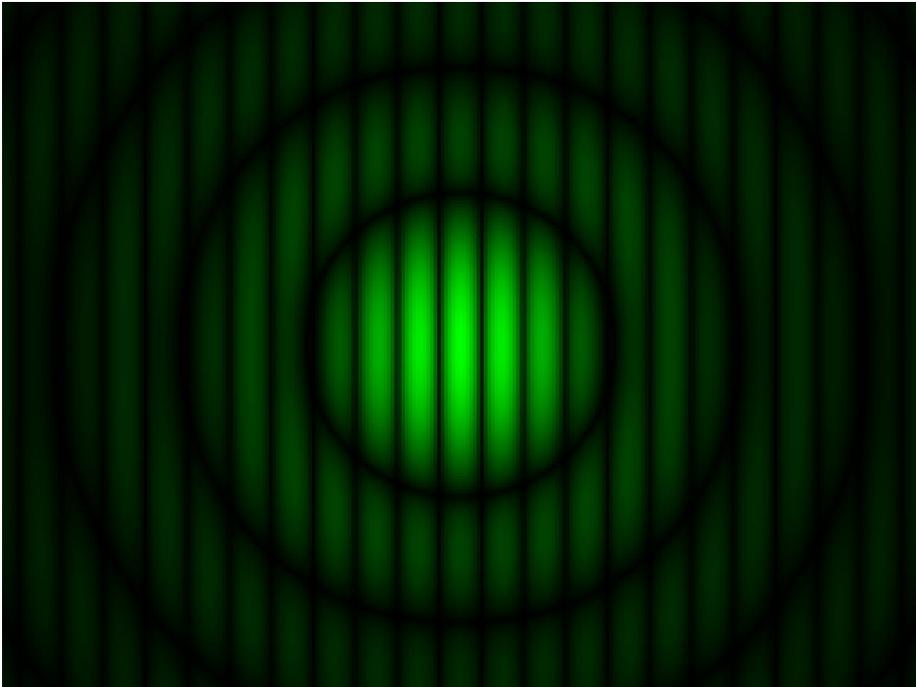
Bild 3: So sieht man eine entfernte, annähernd punktförmige Lichtquelle durch zwei kleine, dicht nebeneinander in eine Alufolie gestochene Löcher. Die Streifen im oberen Bild kommen durch den in Abb. 2 gezeigten Überlagerungseffekt zustande. Das Streifenmuster wird etwas deutlicher gesehen, wenn ein Farbfilter in den Strahl gehalten wird (Rot oder Grün am besten).
