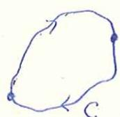
$$-\oint_C \vec{F} \cdot d\vec{r} = \oint_C \vec{\nabla} V \cdot d\vec{r} = \oint_C dV = V_{\text{ENDE}} - V_{\text{ANFANG}} = 0$$
