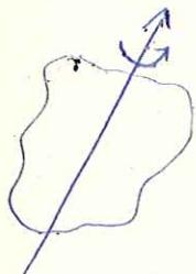
Das System besitzt dann nur einen Freiheitsgrad, nämlich den Drehwinkel  $\varphi$  um die Achse.
