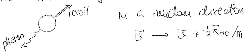
$$\vec{v} \rightarrow \vec{v} + \frac{\hbar}{m} \vec{E}_{\text{rec}}$$
