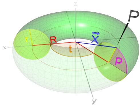
Das Bild zeigt eine Torusfläche, dessen Mittelkreis wir uns als Kreis vom Radius  $R$  in der  $xy$ -Ebene um den Ursprung denken. Die Torusfläche besteht dann in einem Schlauch vom Radius  $r < R$  um den Mittelkreis. Sie wird durch zwei Winkelkoordinaten  $x^1 = t$  (Längengrad) und  $x^2 = p$  (Breitengrad) parametrisiert, so dass (wir schreiben, der Vorlesung folgend,  $\vec{z}$  statt  $\vec{x}$ ):
