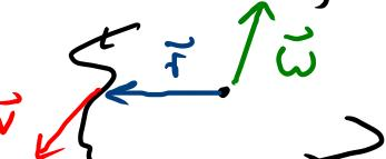
Geschw.:  $\vec{v}(t) = \vec{\omega}(t) \times \vec{r}(t) \quad (2.6)$
