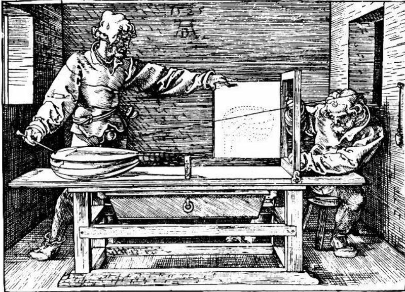
Bild 28: Ein Holzschnitt von Albrecht Dürer, der die mühsame Aufnahme eines perspektivischen Bildes einer Laute zeigt. Der Schnittpunkt des Fadens mit der Bildebene wird durch Messen festgehalten, dann wird die Zeichenfläche nach vorne geklappt und der Punkt übertragen. Das entstehende Bild ist streng genommen nur für den Fall korrekt, daß sich das Auge des Betrachters an der Stelle der Öse an der Wand befindet.
