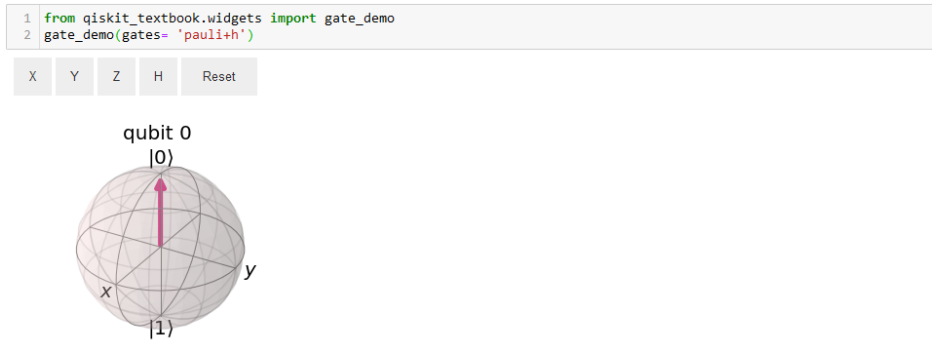
Abbildung 3.9.: Das Widget veranschaulicht die Wirkung der Ein-Qubit-Gatter anhand der Bloch-Kugel.
