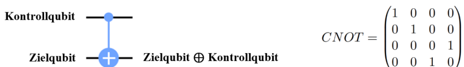
Abbildung 2.15.: Ein verwendetes Schaltsymbol für das CNOT-Gatter und die dazugehörige Matrix.
