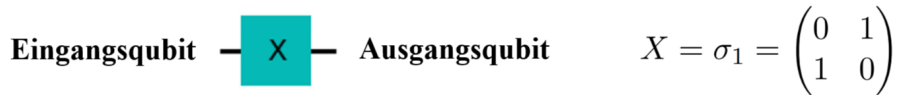
Abbildung 2.10.: Ein verwendetes Schaltsymbol für das X-Gatter und die dazugehörige Matrix. Charakteristisch ist das „X“ innerhalb des Gattersymbols.
