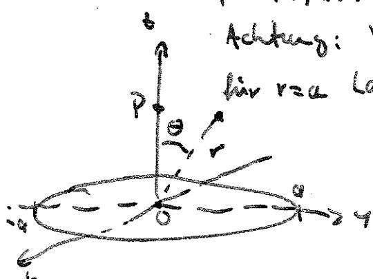
$$(r>a) \quad \left\{ \begin{array}{l} u \rightarrow 0 \text{ für } r \rightarrow \infty \\ m=0 \text{ da System axial symmetrisch ist} \end{array} \right.$$
